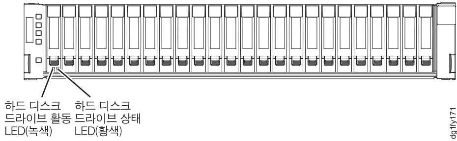
그림 99. DS3524 스토리지 서브시스템 및 EXP3524 스토리지 격납장치 드라이브 LED
