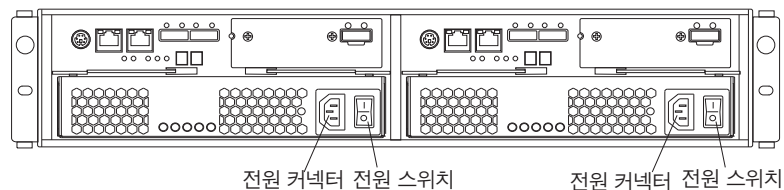
그림 9. AC 전원 공급 장치 구성요소
