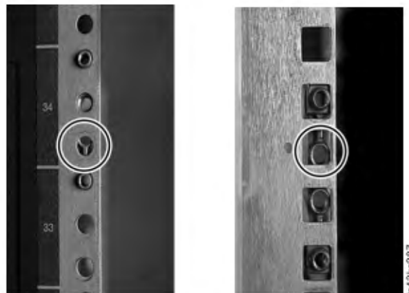
Figure 37. Emplacements de connecteur incorrects
