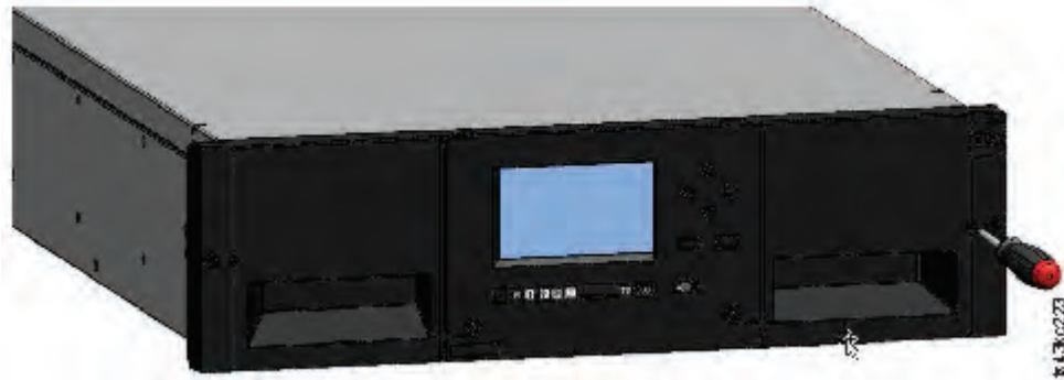
Figure 93. Déchargement manuel du magasin droit
