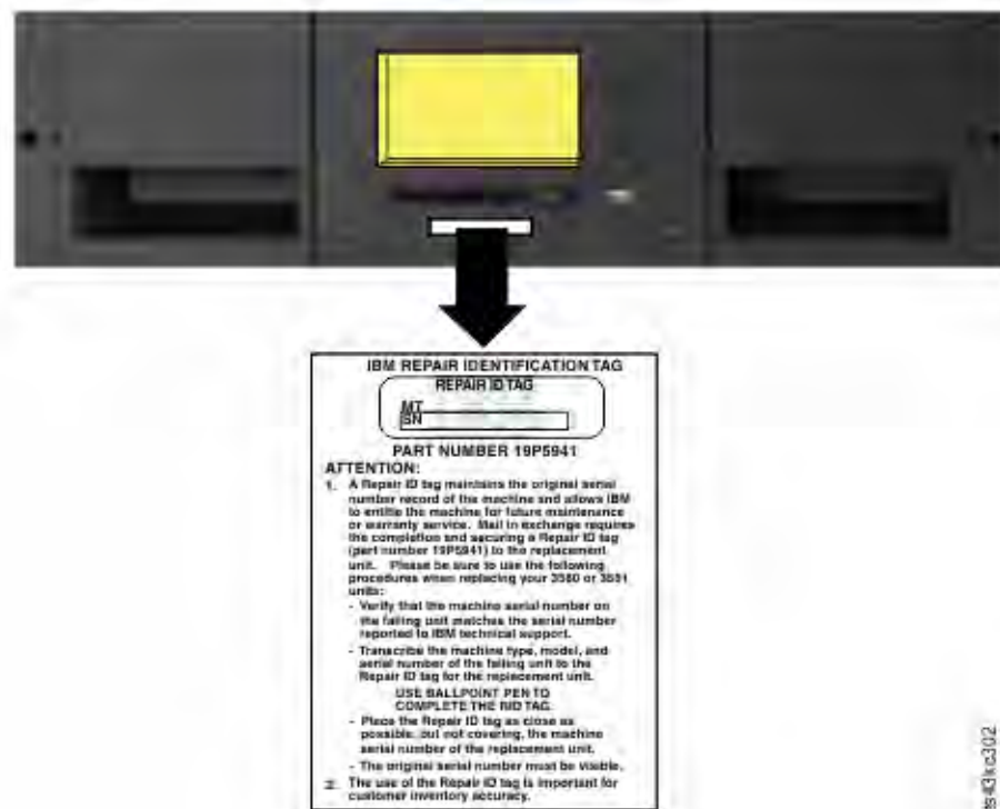
Figure 75. Application de l'étiquette RID (module de base illustré)
