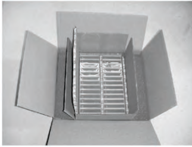
Figure 100. Double emballage des cartouches de bande en vue de l'expédition
