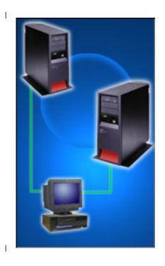
□ この例では、2 つの異なる IBM システムを管理するために HMC が使用されています。たとえば、HMC は各システムを強化したり、各システムの論理区画を構成したりすることができます。さらに、HMC は各 □ システムの状態および各システムの論理区画の状態をモニターします。各システムがクラスター・ノードで □ あり、かつクラスター・リソース・サービスが 2 つのクラスター・ノード間のハートビートをモニターし □ ているものとします。
