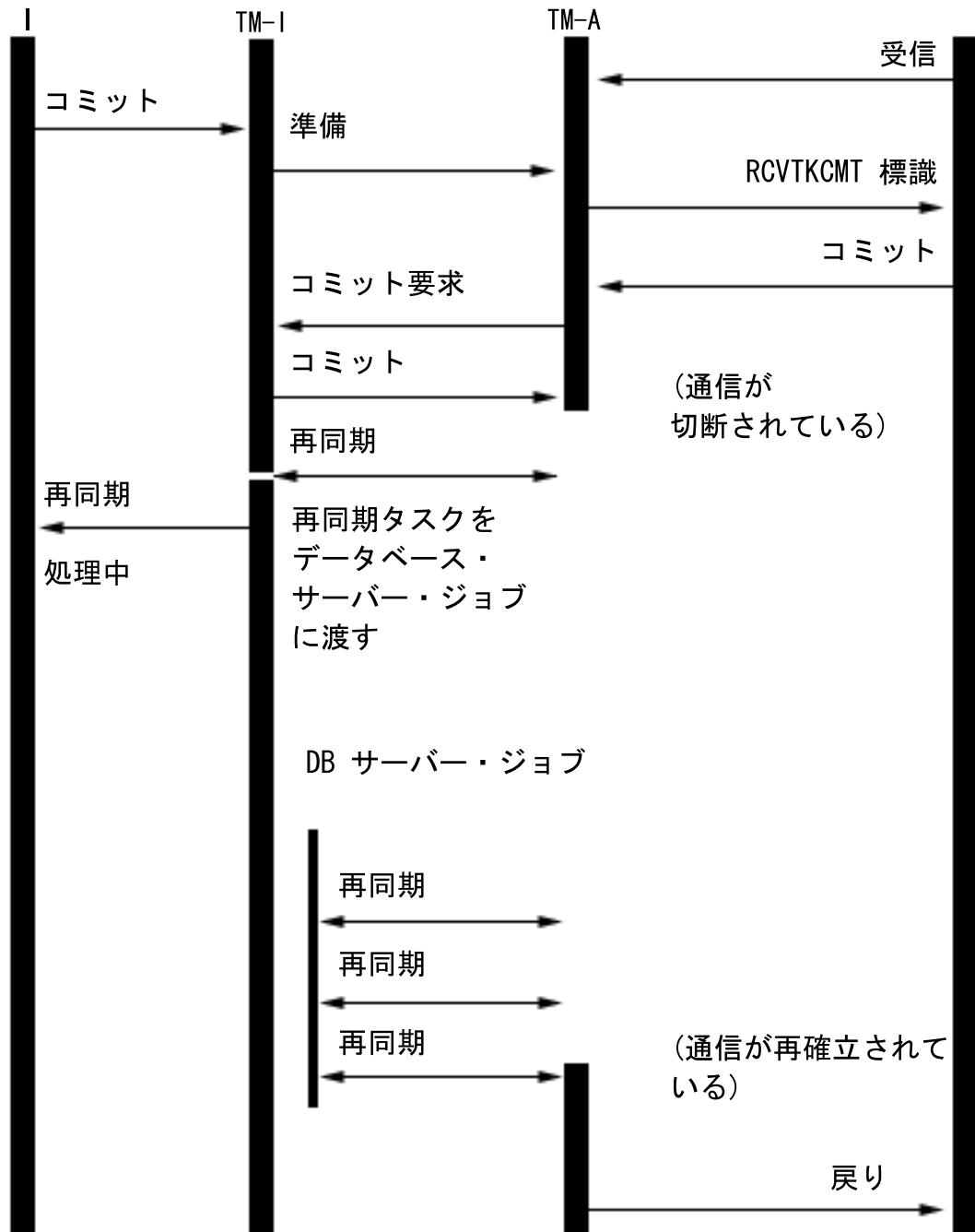
リモート・リレーショナル・データベースへの接続が確立されるときに、保護会話がまだ開始されていないと、システムは結果の待機の値を暗黙的に N に変更します。この理由は、結果の待機の値が N で、リモート・システムが presumed abort をサポートする場合に、コミット操作のパフォーマンスが向上するためです。この結果の待機の値の暗黙的な変更は、DRDA および DDM アプリケーションでのみ実行されます。APPD アプリケーションでは、QTNCCHGCO API を呼び出して変更しない限り、デフォルトの結果の待機の値 Y が使用されます。
