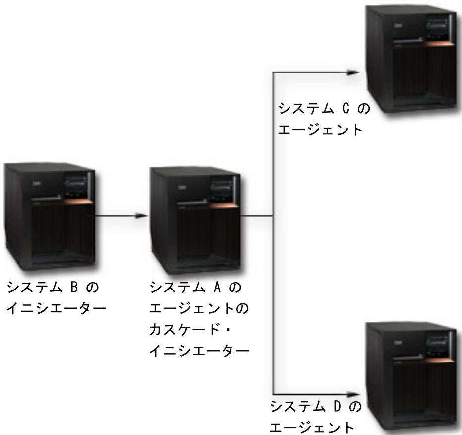
システム B はシステム C およびシステム D と直接通信していないので、トランザクション・プログラム・ネットワークには別のレベルがあります。システム A のリソース・マネージャーには、エージェントとしての役割と、カスケード・イニシエーターとしての役割があります。
