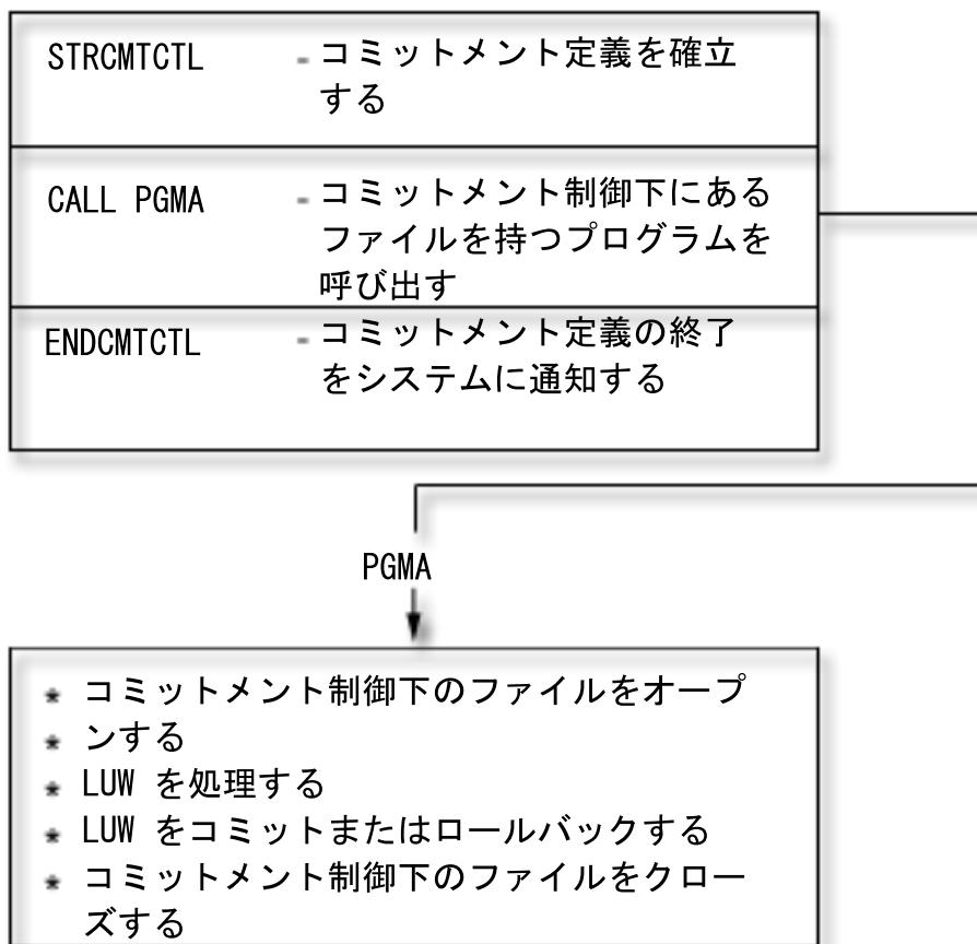
コミットメント制御下で実行される操作はジャーナルに記録されます。コミットメント制御開始ジャーナル項目は、コミットメント制御下の最初のファイル・オープン項目の後に現れます。これは最初のファイル・オープン項目がコミットメント制御にどのジャーナルを使用するかを決定するためです。さらに最初のオープン操作からのジャーナル項目を使用して 2 回目以降のオープン操作を検査し、すべてのファイルが同じジャーナルを使用することを確認します。
