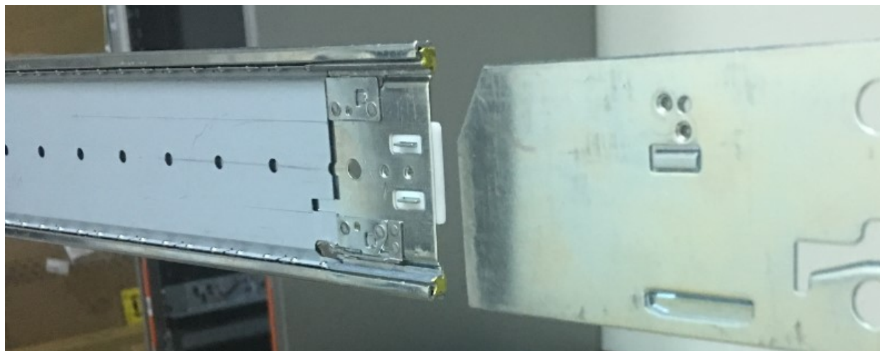
Figura 40. Detalhes do alinhamento do slide de trilho
