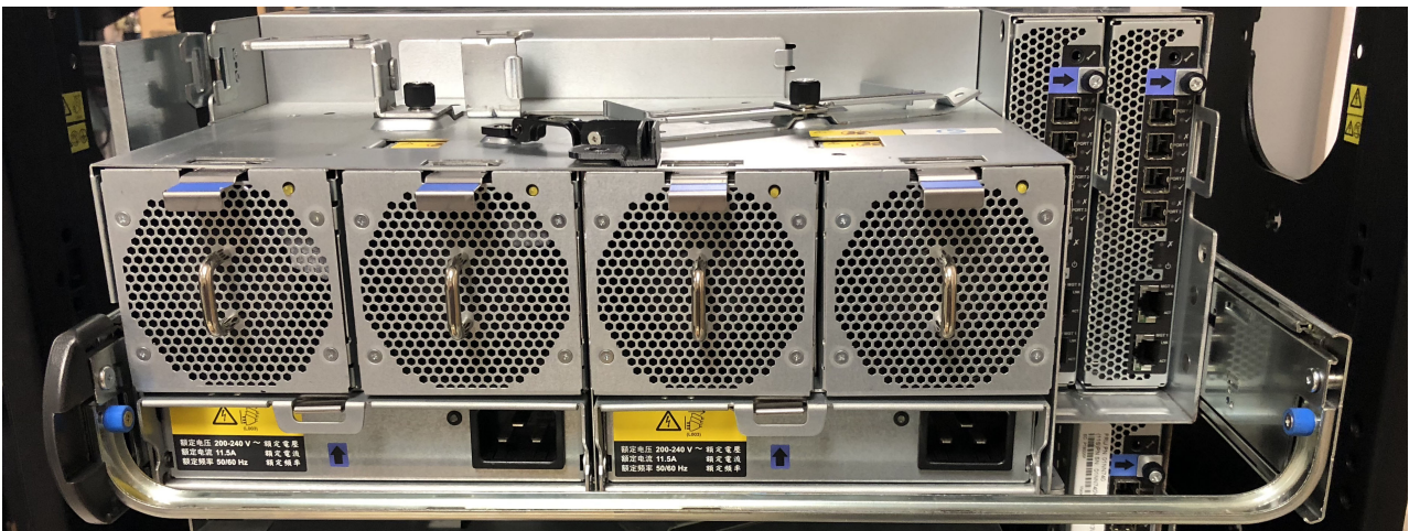
Figura 49. A trave com parafusos de aperto manual azuis estabiliza os dois trilhos na parte traseira do chassi
