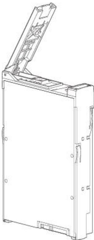
Figura 72. Módulo da transportadora de unidade LFF na posição aberta
