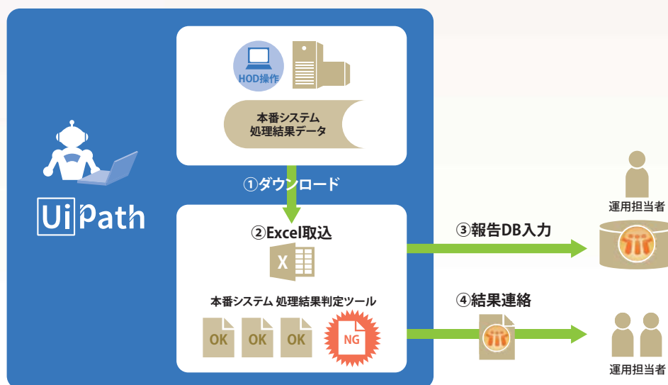
前日夜間に処理されたホストの結果ファイルをダウンロード。 そこから必要な情報を抽出して報告データベースに入力し、関係者にメールで連絡。
