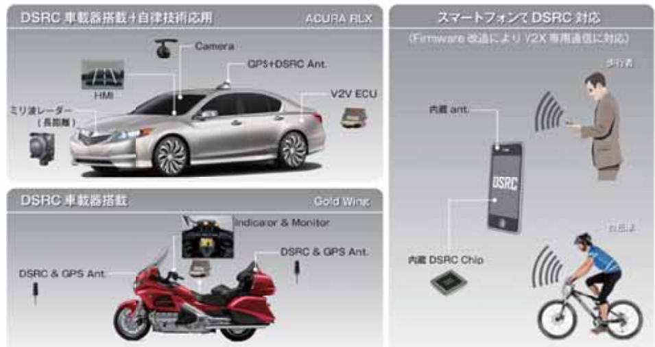
●DSRC (Dedicated Short Range Communications) は、車両との無線通信に特化した専用狭域通信技術で、日本ではETCやVICSなどでも用いられている。
