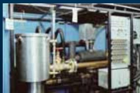
IBM3086冷却水分配装置。チラーからの冷却水を分配する装置で、S/360とS/370で使用されました。
