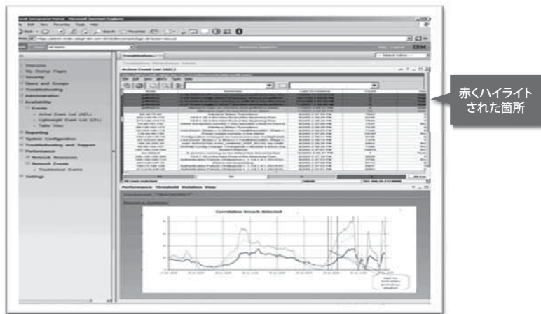
因果関係の崩れがアラームとして通知される。画面上でアラームを選択すると、因果関係のあるKPI値が多変量(複合)的にグラフ化され、平常時の性能値の推移、因果関係が崩れた箇所が赤くハイライトされ確認できる。
