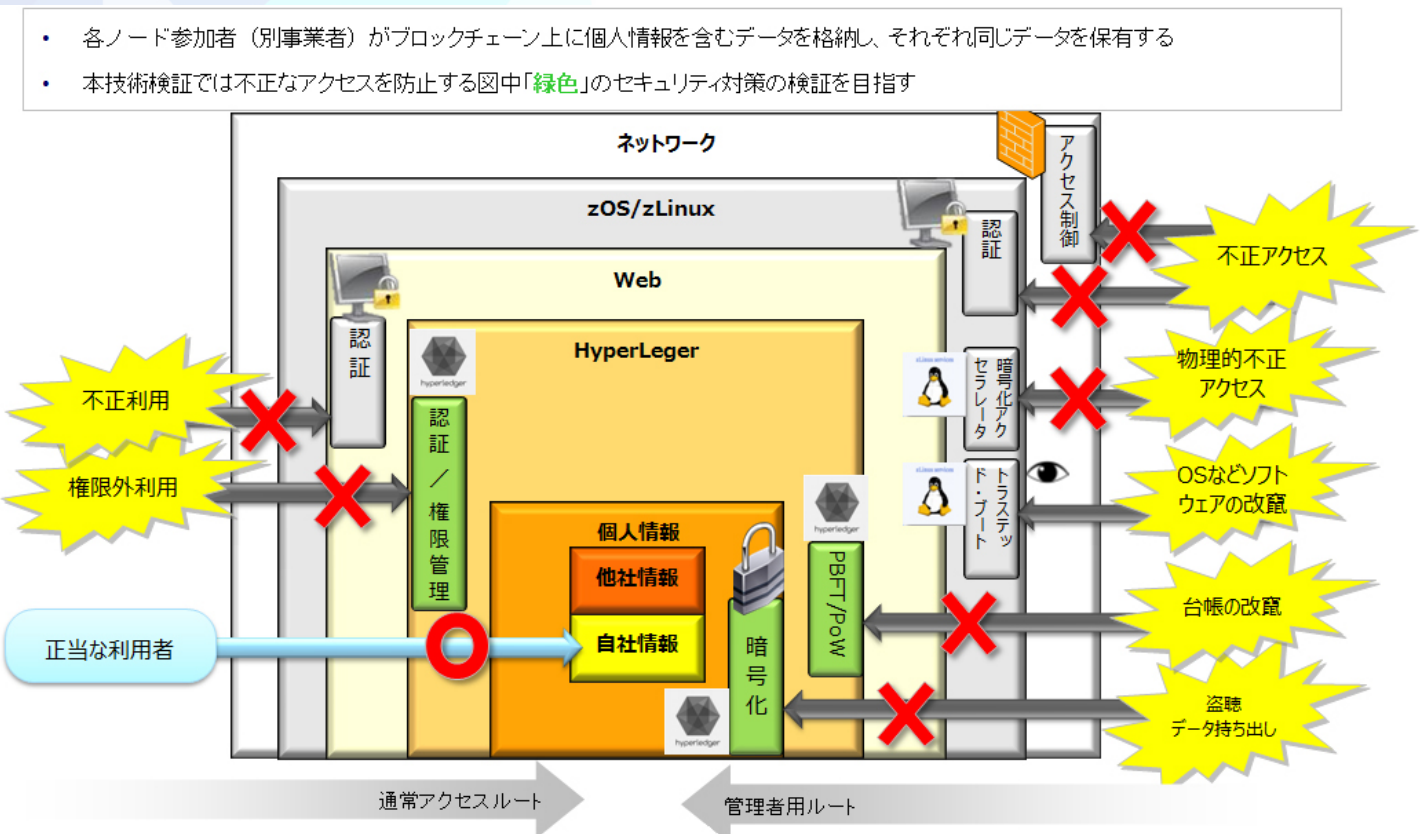
図2 Hyperledger Fabric を使った実証実験におけるセキュリティ面の検証ポイント
