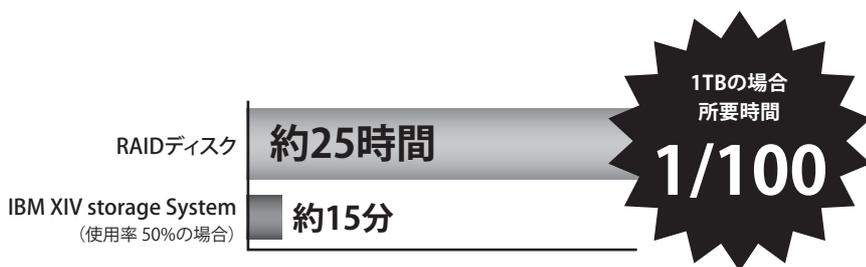
図3. 分散ミラーリング技術による障害時のデータ復旧時間の差
