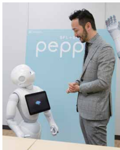
Pepperは二足歩行ではなく、360度移動できる特殊な車輪を採用し、バッテリー持続時間を考慮。一方で、手や指は自然な動きになるよう作られている。
