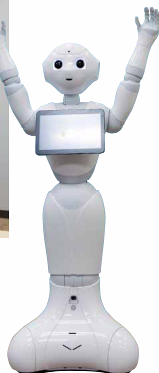
Pepperは二足歩行ではなく、360度移動できる特殊な車輪を採用し、バッテリー持続時間を考慮。一方で、手や指は自然な動きになるよう作られている。
