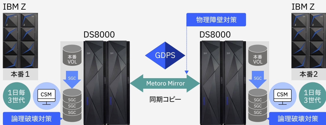
(図5) セーフガード・コピー事例：金融サービス業の高可用性システム
