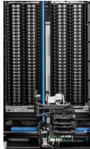
Innenansicht der IBM TS4500 Tape Library
