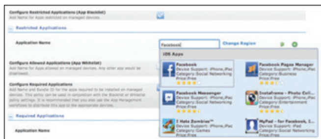
Figura 4: Ejemplo de cómo se puede incluir una aplicación en la lista negra para que no pueda instalarse en un dispositivo
