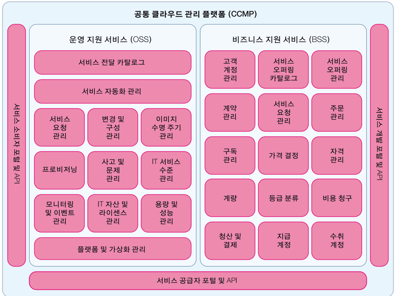
그림 4: 공통 클라우드 관리 플랫폼 (CCMP)의 구성요소는 CCMP 자체 및 모든 계층의 클라우드 환경에 대한 운영 및 비즈니스 관리를 수행합니다.
