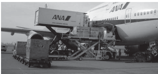
図2. 航空機へのULDの搭載状況
