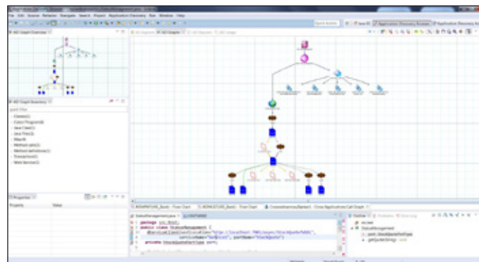
Figura 3: ADDI analiza las relaciones entre los componentes de las aplicaciones
