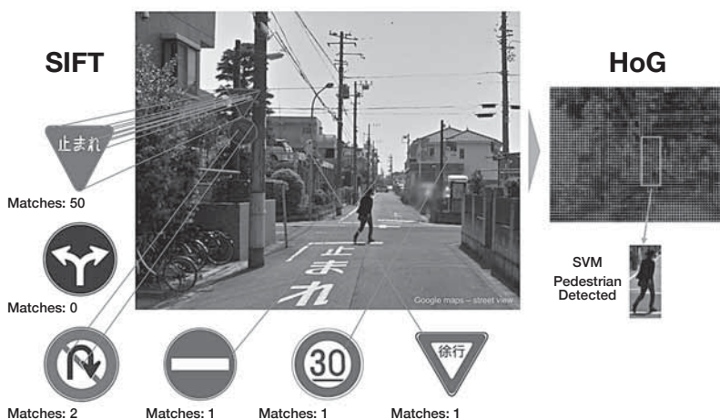
図1. 汎用の特徴表現と道路標識認識への応用
