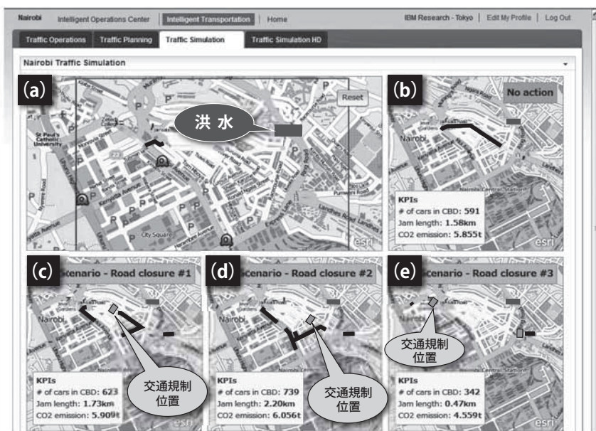
図3. 洪水発生時の what-if シミュレーションの例
