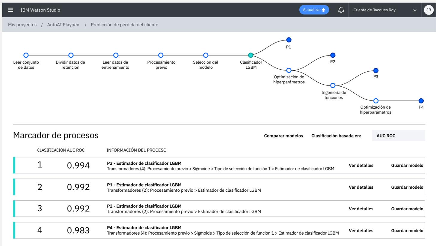
Figura 1. El marcador de AutoAI muestra los procesos de modelos posibles.
