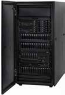
그림 2-3: 단일 캐비닛에 모든 구성 요소가 있는 엔터프라이즈 스토리지 어레이
