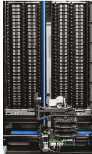
Внутреннее устройство ленточной библиотеки IBM TS4500
