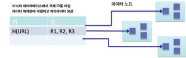
그림 1: 클라우드 객체 스토리지 - 파일 데이터를 메타데이터 식별에서 분리하여 기본 스토리지에 파일 데이터 분산
