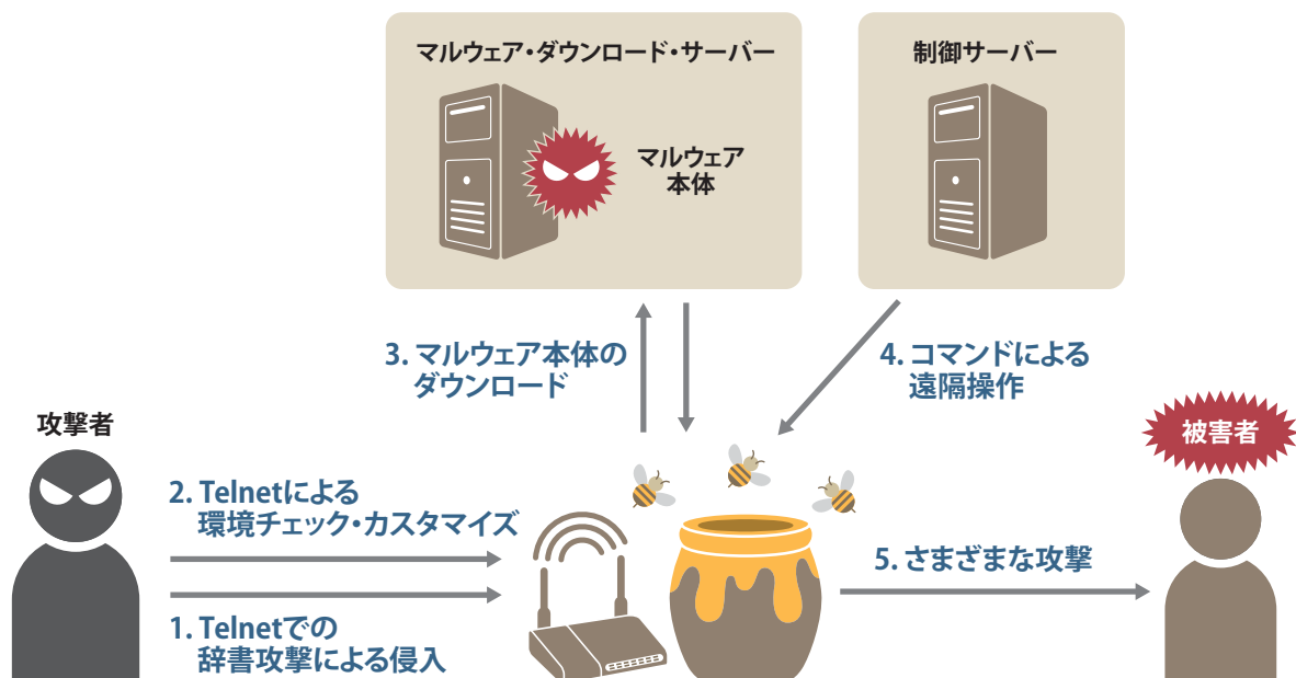
図2. Telnetベースのマルウェア感染の流れ
