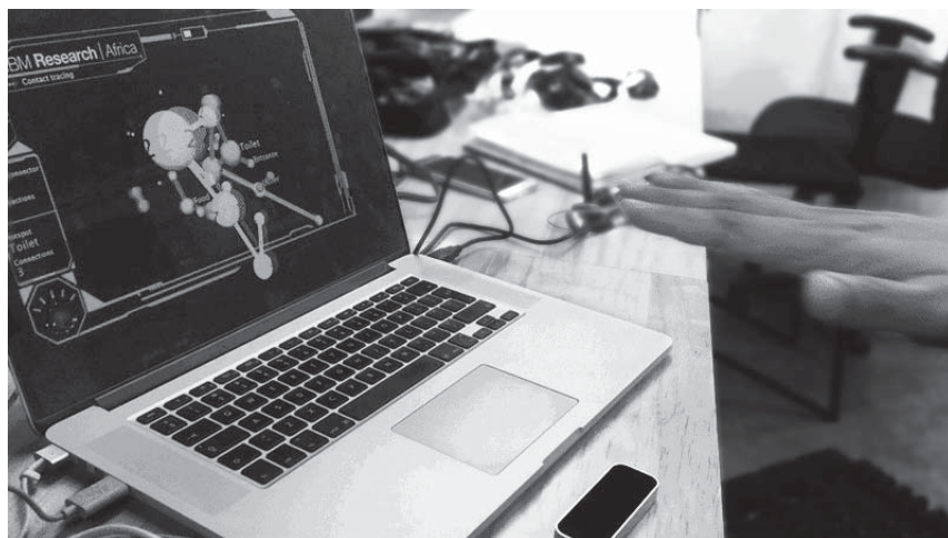
図1. RFIDタグの接触データを3次元で可視化。手の動きに合わせて3Dモデルが回転する様子
