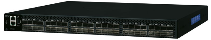
5세대 파이버 채널 스위치는 16 Gbps 성능 및 에너지 효율적인 1U 폼 팩터에서 최대 48개의 포트를 지원하는 기능이 있습니다.
