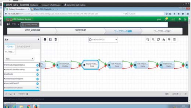
図3. 復旧手順をワークフロー化して登録が可能 また、稼働確認済みの操作を復旧自動化ライブラリー(RAL)として参照が可能
