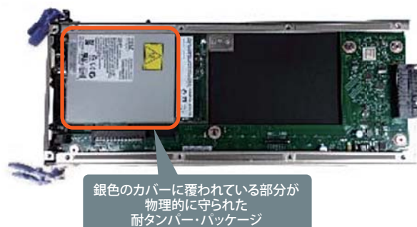
図1. IBM z13のCrypto Express5S
