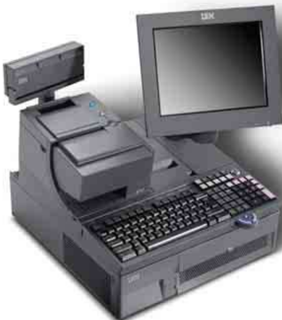
Модель 783 системы SurePOS 700 с 15-дюймовым дисплеем SurePoint™, принтером SureMark™ на две станции, клавиатурой ANPOS с устройством указания, дисплеем покупателя 2X20" и интеграционной панелью
